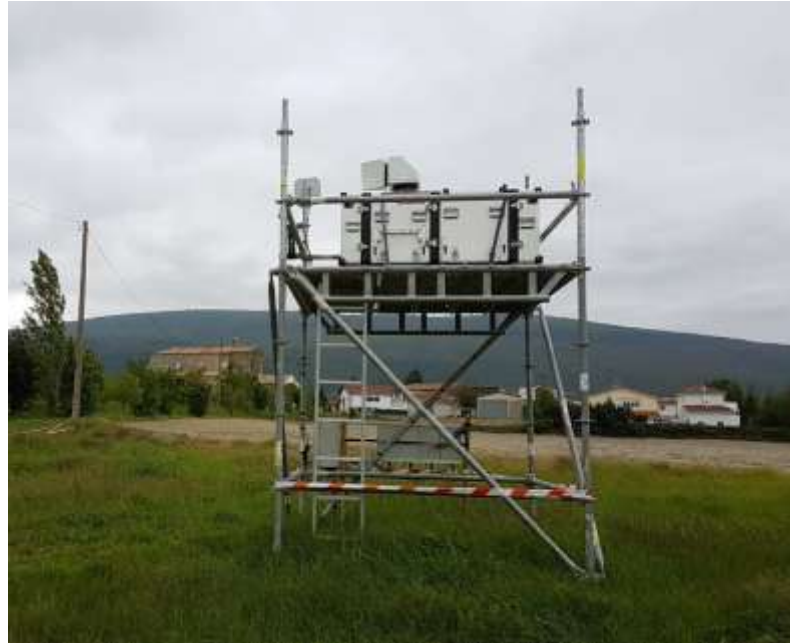
Figura 3 Imagen del equipo WindScanner instalado en Elorz.
