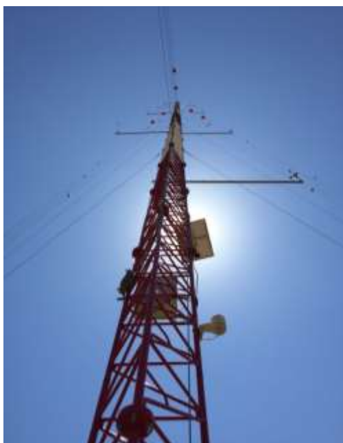
Figura 1 Imagen de mástil de medición de 80 metros de altura.
